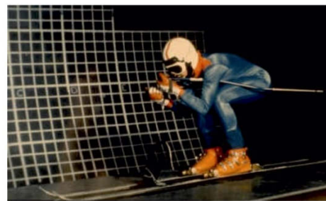
recherche de l'optimisation de la position d'un skieur en soufflerie
