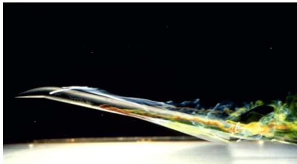
écoulement autour du Concorde maquette 1/150 Visualisation par filets colorés
