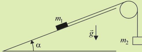
1) Calculer dans l'hypothèse du glissement l'accélération du palet en fonction de  $m_1$  et  $m_2$ ,  $\alpha$ ,  $\mu$  et de l'intensité  $g$  du champ de pesanteur. À quelle condition sur  $m_2/m_1$  le palet remonte-t-il la pente ? descend-il le long de la pente ?
