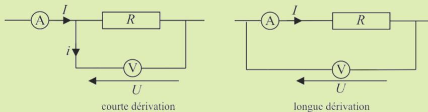
1) Exprimer, pour chaque montage,  $R_{\text{mes}}$  en fonction de  $R$ ,  $R_V$  et  $R_A$ , puis l'erreur relative  $\frac{R_{\text{mes}} - R}{R}$ , supposée faible.
