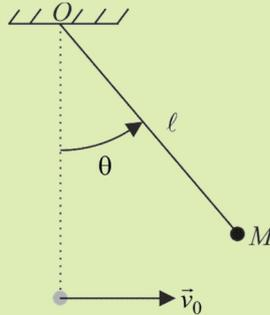
**réponse :** Pour  $v_0 > \sqrt{5g\ell}$  le pendule effectue indéfiniment des révolutions autour de  $O$ . Pour  $\sqrt{2g\ell} < v_0 < \sqrt{5g\ell}$ , le fil n'est plus tendu pour un angle  $\theta_d$  tel que  $\cos\theta_d = \frac{2}{3} - \frac{v_0^2}{3g\ell}$  : le point matériel amorce alors un mouvement parabolique. Pour  $v_0 < \sqrt{2g\ell}$ , le pendule oscille autour de sa position d'équilibre  $\theta = 0$
