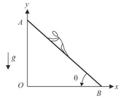
1) À quelle condition sur  $\mu$  y a-t-il équilibre de l'ensemble quelle que soit la position de l'individu sur l'échelle ? Quelle est l'influence de  $\theta$  ?
