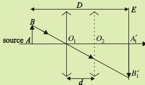
Montrer qu'il existe une position particulière de  $A$  pour laquelle l'image  $A'B'$  donnée par le système catadioptrique {lentille  $L$ , miroir plan  $M$ } se trouve dans le même plan de front que  $AB$ . Préciser cette position et la nature complète de  $AB$ . En déduire une méthode de mesure de la distance focale de  $L$ .
