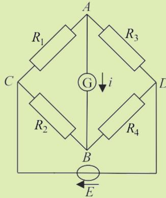
2) On peut remplacer le dipôle AB extérieur à la branche centrale par un générateur de Thévenin de résistance interne  $R_{eq}$ . Montrer que  $R_{eq}$  est la résistance entre A et B quand  $E = 0$ , puis la calculer. En déduire  $i$  en fonction de  $e_{AB}$ ,  $R_{eq}$  et  $r$ .
