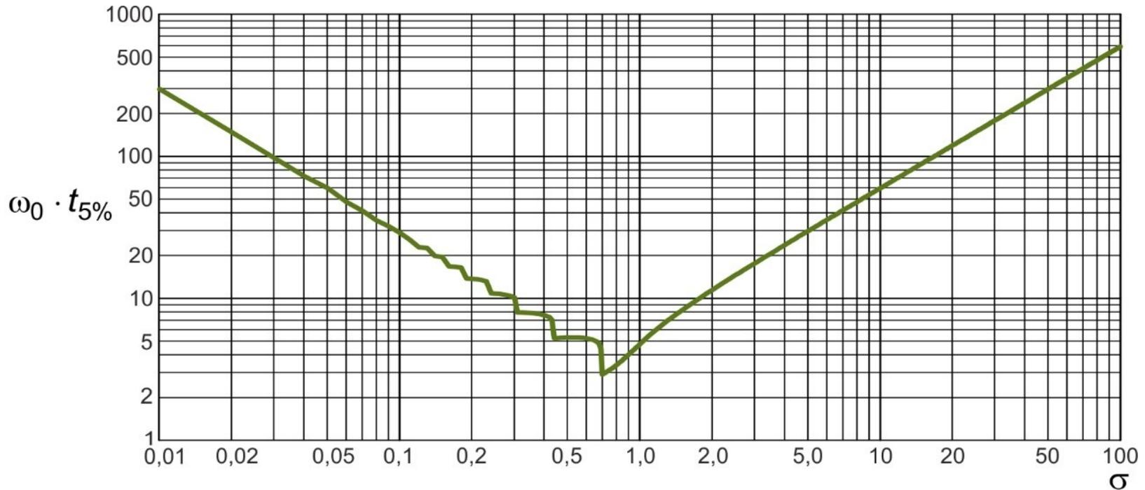
Le temps de réponse à 5% est minimal pour  $\sigma = 0,69$ , valeur pour laquelle le système oscille
