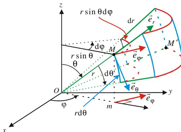
2) Déterminer en utilisant les déplacements élémentaires de la figure ci-contre l'expression de  $\text{div } \vec{A}$  en coordonnées sphériques.
