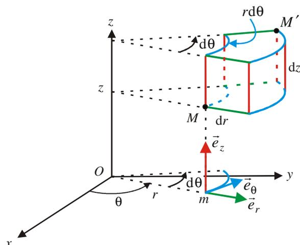
2) Déterminer en utilisant les déplacements élémentaires de la figure ci-contre l'expression de  $\text{div } \vec{A}$  en coordonnées cylindriques.
