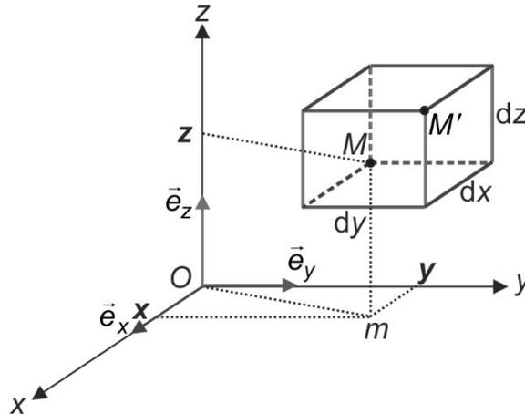
On définit le repère orthonormé *direct*  $(O, \vec{e}_x, \vec{e}_y, \vec{e}_z)$  :  $\vec{e}_z$  est orienté dans le sens de déplacement d'un tire-bouchon quand on tourne de  $\vec{e}_x$  vers  $\vec{e}_y$ .
