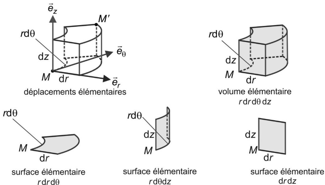
Le parallélépipède représenté sur la figure précédente permet de calculer l'élément différentiel de volume en coordonnées cylindriques :  $d^3\mathcal{V} = r dr d\theta dz$ .
