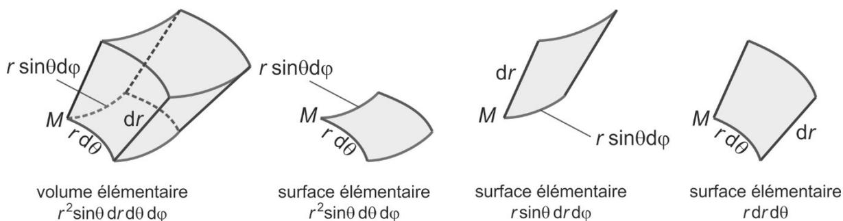
Le parallélépipède représenté sur la figure ci-avant permet de calculer l'élément différentiel de volume en coordonnées sphériques :  $d^3\mathcal{V} = r^2 \sin\theta dr d\theta d\varphi$ .
