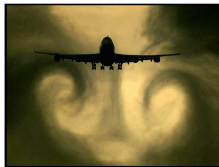
vortex de bout d'aile d'un avion
