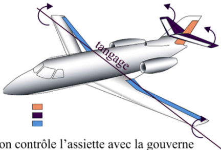
on contrôle l'assiette avec la gouverne de profondeur
