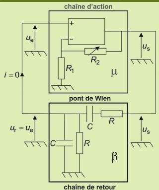
La chaîne d'action est un montage amplificateur non inverseur, dont la fonction de transfert est  $\mu = \frac{u_{\rm S}}{u_{\rm e}} = 1 + \frac{R_2}{R_1}$ . La chaîne de retour est un pont de Wien, passe-bande du second ordre, dont la
