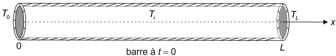
À partir de  $t = t_0 = 0$ , on porte l'extrémité  $x = 0$  de la barre à la température  $T_0$  et l'extrémité  $x = L$  à  $T_L$ . La température dans la barre est solution de l'équation de la chaleur à 1D :
