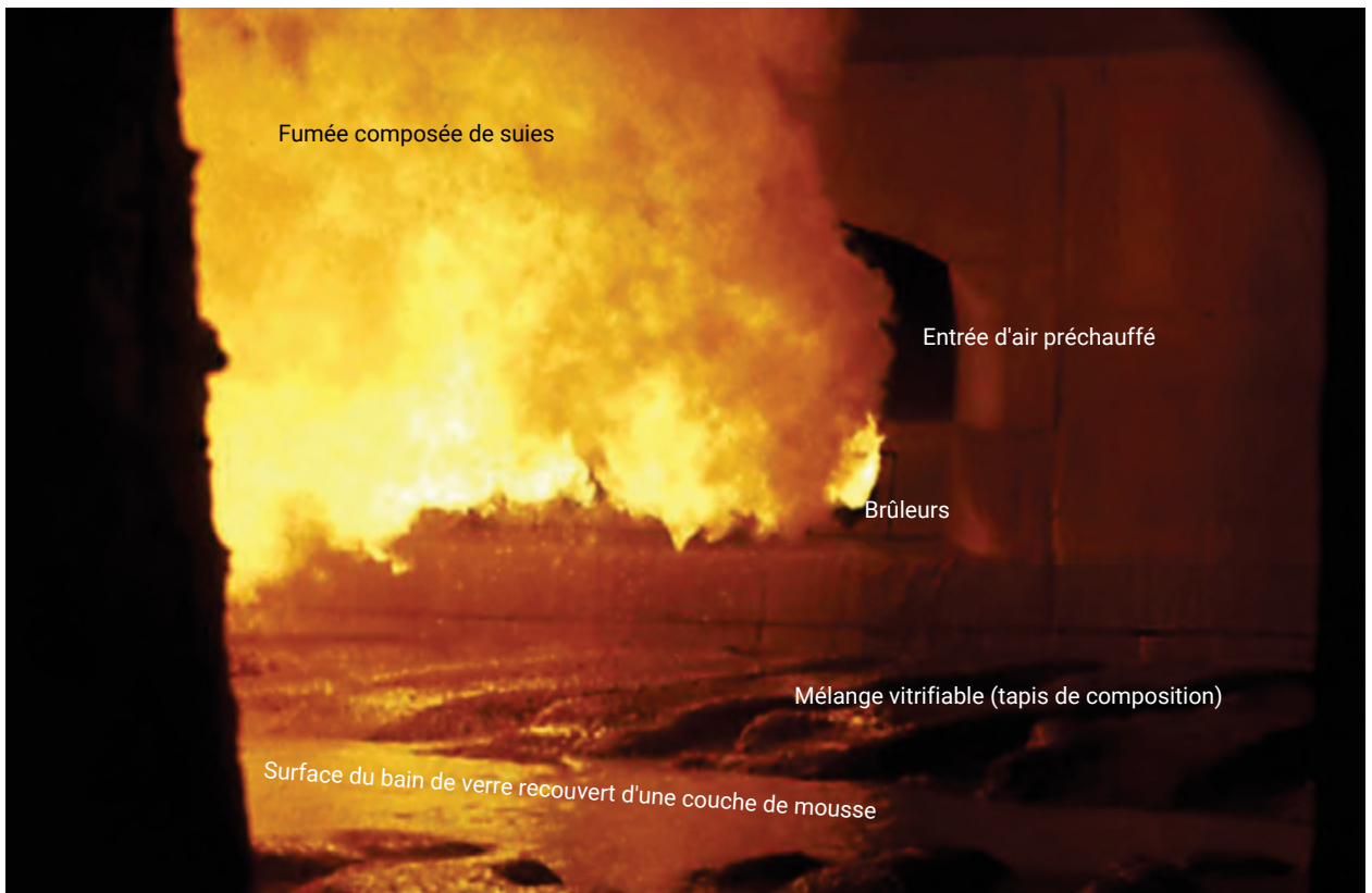
1. Vue de l'intérieur d'un four verrier avec, à la surface du bain, une couche correspondant à la matière première, où se trouve aussi une écume formée par le dégazage. Au-dessus du bain de liquide, des flammes provenant de la combustion d'un gaz et de l'air produisent l'énergie nécessaire à la fusion.
