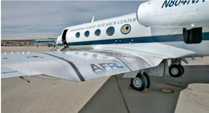
Figure 1 : Essai du concept VCCTEF par la NASA (gauche), et démonstrateur du projet européen SARISTU (droite)
