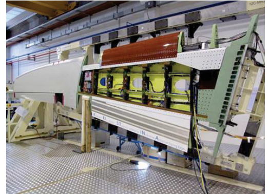
Figure 1 : Essai du concept VCCTEF par la NASA (gauche), et démonstrateur du projet européen SARISTU (droite)
