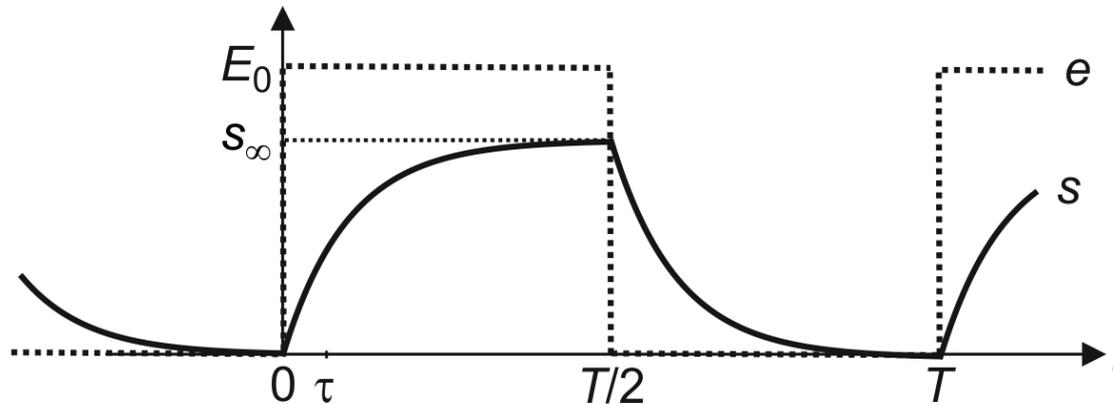
Réponse à des créneaux de faible fréquence : on a  $s(0^-) \approx 0$  et la réponse entre  $t = 0$  et  $T/2$  est bien la réponse indicielle.
