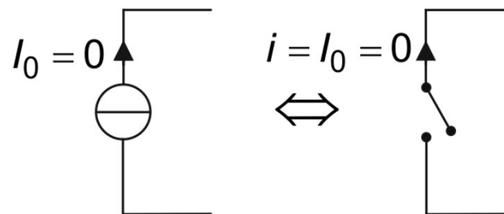
Une source de courant éteinte est équivalente à un interrupteur ouvert.
