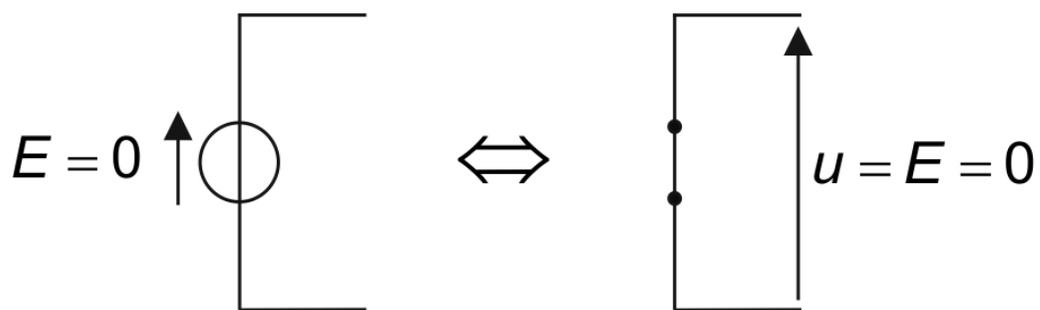
Une source de tension éteinte est équivalente à un interrupteur fermé.
