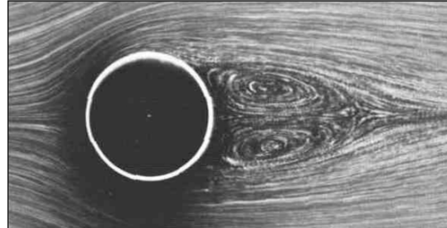
Re = 26 . Perte de symétrie, apparition d'une zone de recirculation. L'écoulement est encore stationnaire.
