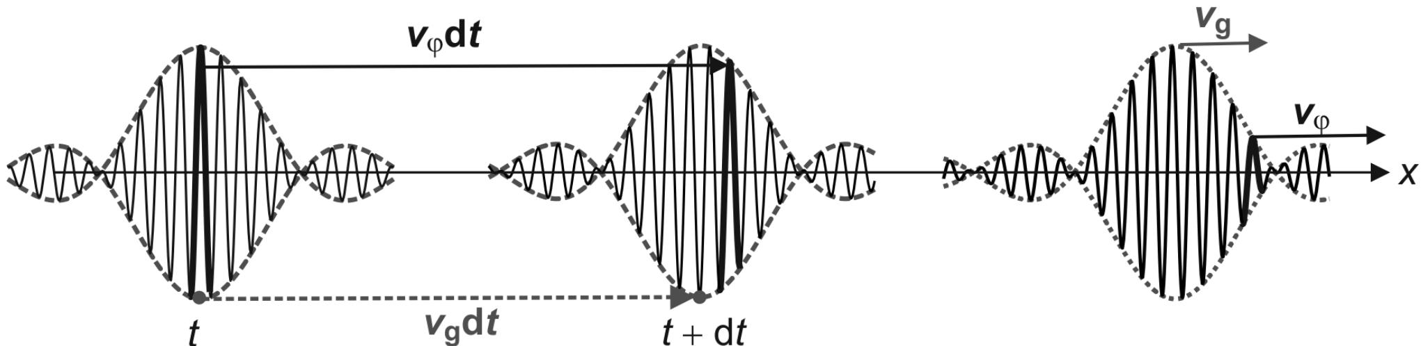
$v_g$  a un sens physique car l'enveloppe transporte de l'information pour une onde *électromagnétique*  $v_g \leq c$  célérité de la lumière dans le vide analogie avec la modulation d'amplitude : la « porteuse » ne véhicule aucune information, contrairement au signal modulant qui enveloppe la porteuse
