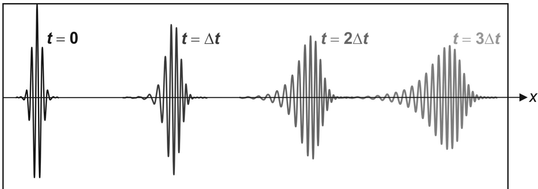
ici les composantes de plus grandes fréquences se propagent plus vite que celles dont les fréquences sont les plus faibles : il y a *étalement* d'un paquet d'ondes lors de sa propagation
