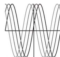
lors de deux passages successifs, le faisceau ne part pas du même point: signal non synchronisé
